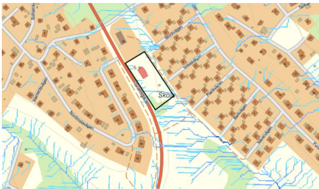
Karta 9: Kartan visar rinnvägar vid skyfall. Svart linje visar detaljplanens ungefärliga planområdesgräns.
