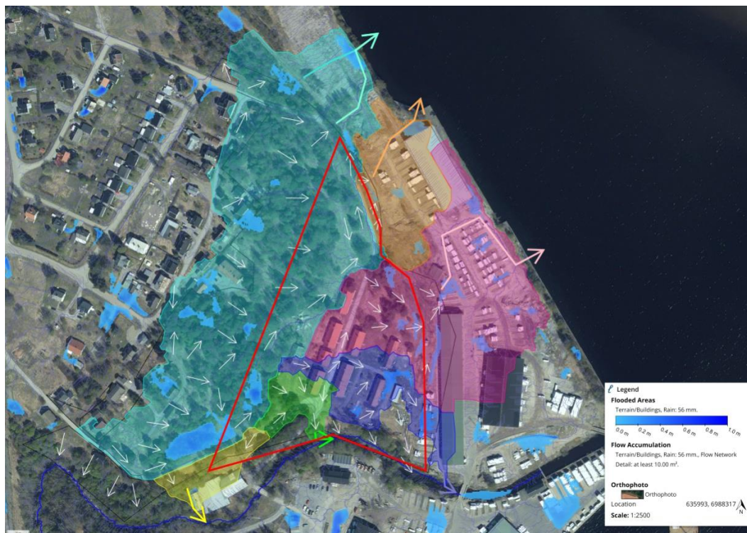
Figur 28, Flödesvägar och lågpunkter med risk för översvämning vid befintlig situation baserat på ett 100-årsregn (56 mm). Pilarna markerar de huvudsakliga avrinningsvägarna inom planområdet.
