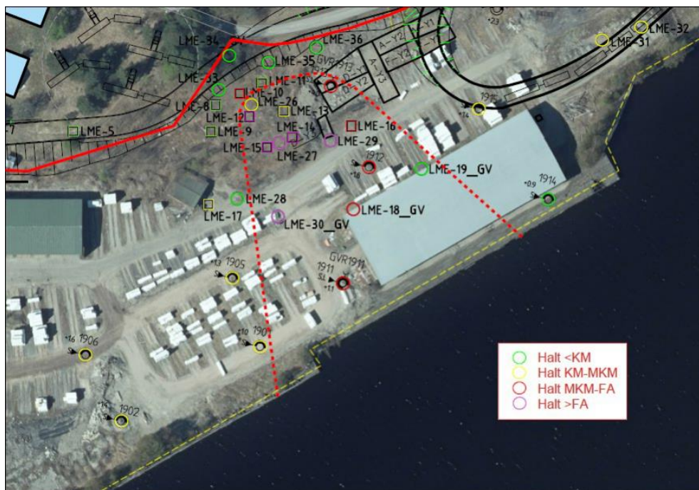
Figur 20: Översiktlig redovisning av resultat för analyserade jordprov i området i anslutning till samt nedströms f.d. impregneringen. Färg på provpunkt anger högsta uppmätta halt i provpunkten. Röd streckad linje anger tänkbar utbredning av kresotförorening. LME Miljö AB 2025.
